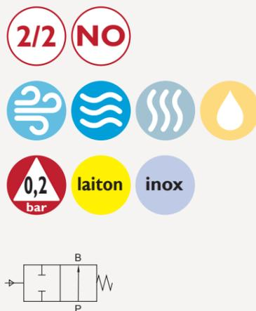
**Vanne commandée par un fluide auxiliaire**
